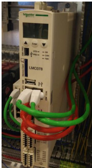
Figur 3.2 Illustrerar styrenheten LMC078
