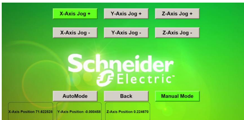
Figur 4.11: Illustrerar hur användargränssnittet ser ut när joggning av motorn sker utan fel
